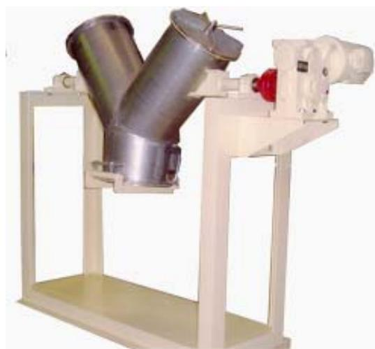
**Fig. 15.** Misturador em Y (mecânico).
