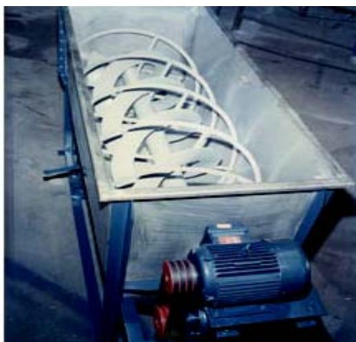
**Fig. 14.** Misturador horizontal (elétrico).
