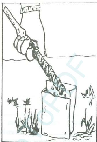
FIG. 7. Amostragem com vazador ou trado.
