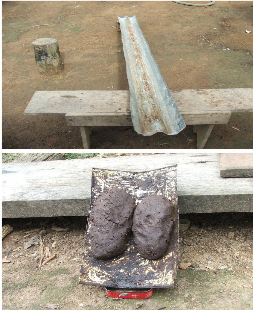
**Fig 4.** Folha de telha de zinco (A) e superfície metálica inclinada (B) utilizada na extração do óleo da massa de andiroba.
