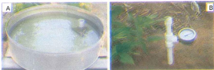
Figura 2 - Métodos utilizados para o monitoramento da água de irrigação. (A) Tanque Classe A e (B) Tensiômetro. Fotos: W. F. Araújo.
