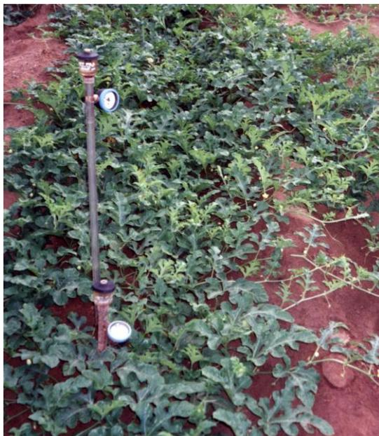
**Fig. 1.** Tensiômetro utilizado para o manejo da irrigação.
