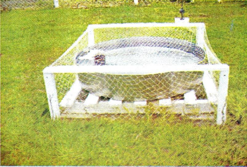
Fig. 2. Detalhe do tanque Classe A equipado com parafuso micrométrico.
