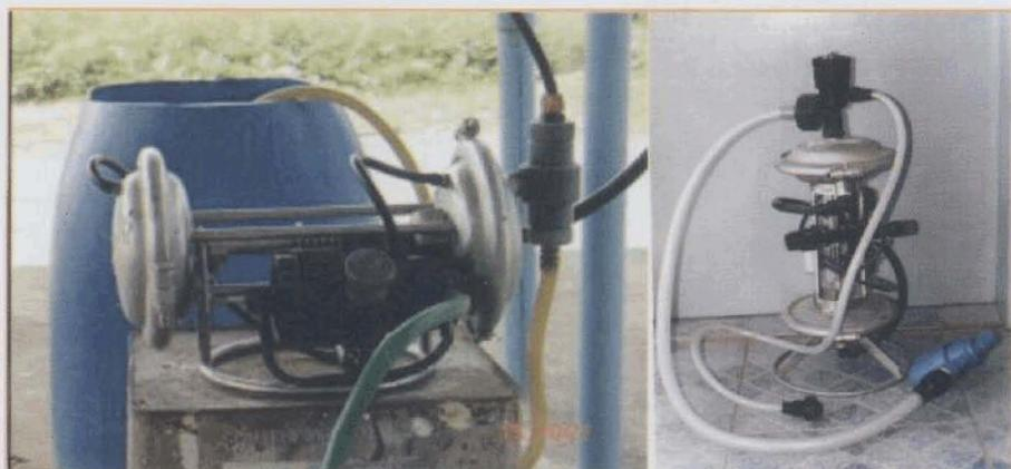
Figura 5. Bomba injetora de ação hidráulica por diafragma (TMB).
