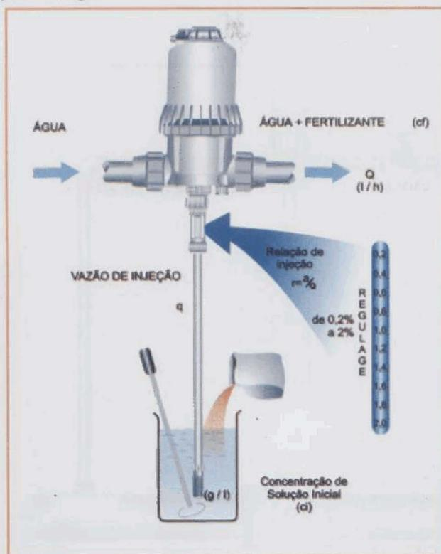
Figura 9. Sistema de operacionalização e regulagem do dosatron para aplicar fertilizantes.
