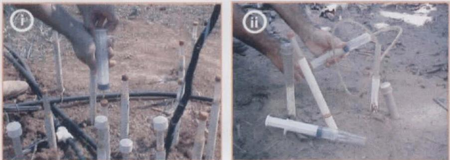
Figura 12. Procedimento da extração de solução do solo utilizando extratores de cápsula porosa e seringa descartável (i) vácuo e (ii) extração da solução.
