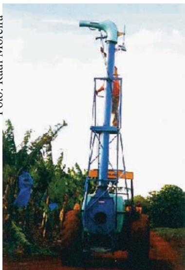
Fig. 50. Aplicação de fungicida com pulverizador tratorizado tipo girafa em bananal no Vale do Ribeira, em São Paulo.
