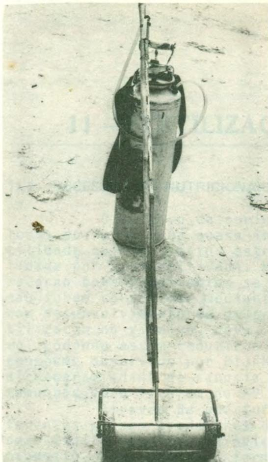
Fig. 1 - "Rodinho" Equipamento completo de aplicação de herbicida em viveiros e jardim clonal. O pulverizador pode ser desacoplado para pulverização de herbicidas com bicos normais.
