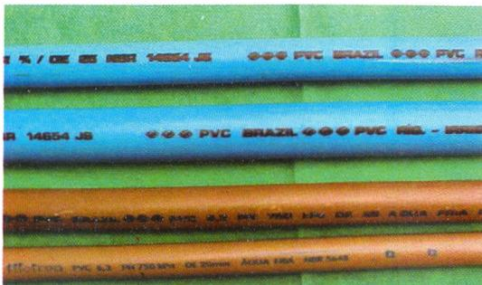
Fig. 3. Tubulações de PVC com diferentes diâmetros
