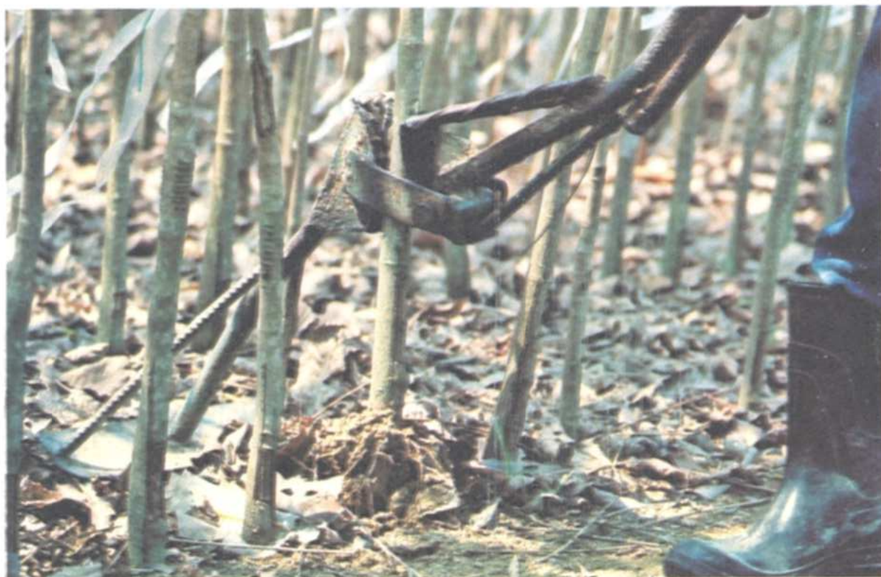
FIG. 4. “Quiiau” – alavanca extratora de mudas de raízes nuas.
