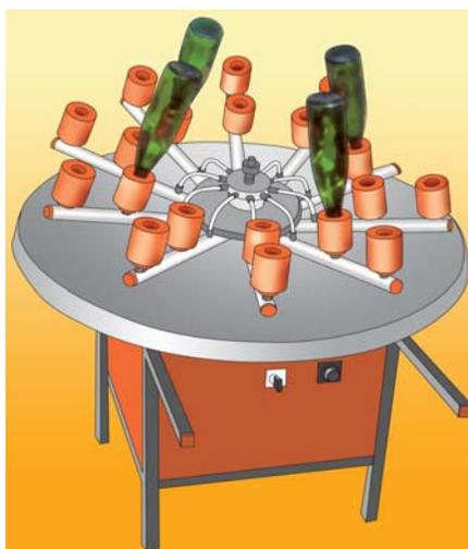
**Figura 4.** Máquina lavadora de garrafas.
