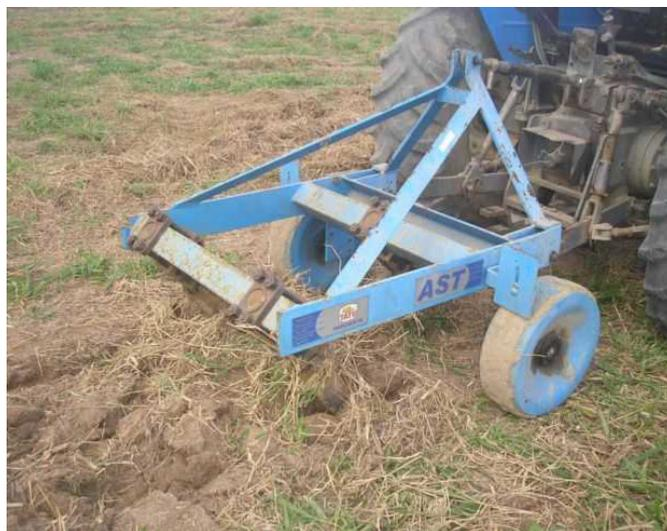
Figura 2. Uso do escarificador para incorporação do calcário no solo
