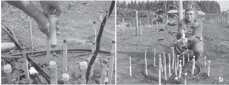
Fig. 20. Procedimento da extração de solução do solo utilizando extratores de cápsula porosa e seringa descartável: (a) vácuo; (b) extração da solução.
