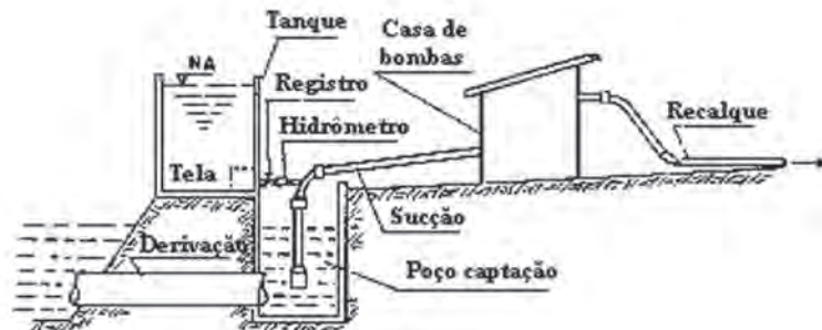
Fig. 7. Esquema de um sistema de injeção por pressão negativa.
