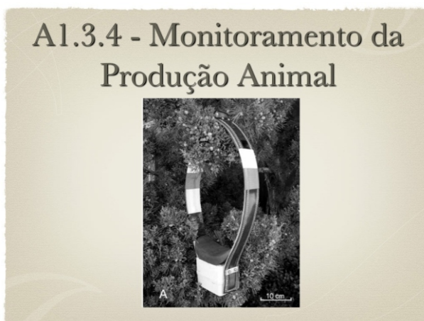
Fig. 5. Exemplo de produto na forma de colar utilizado para a localização de animais ou rebanho através de receptores GPS e transmissores de rádio.
