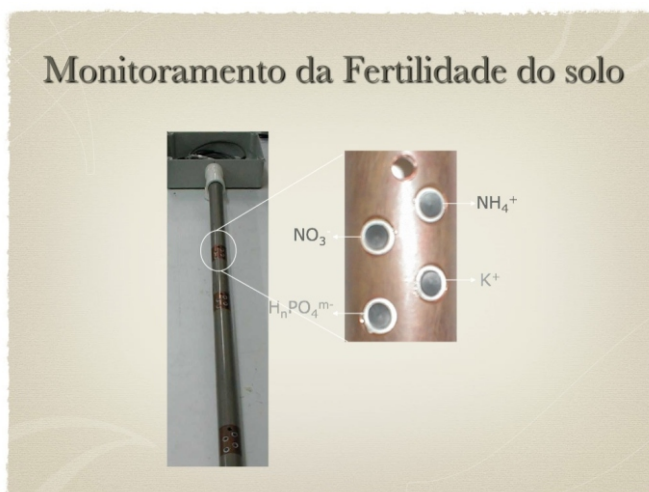
Fig. 4. Sonda de fertilidade do solo desenvolvida com sensores potenciométricos e membranas seletivas a íons para amônia, nitrato, ácido fosfórico e potássio.
