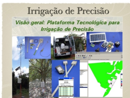
Fig. 3. A Plataforma Tecnológica para Irrigação de Precisão desenvolvida pela Embrapa Instrumentação Agropecuária é composta de diversos componentes de hardware e software, a saber: Nós sensores de umidade e temperatura no solo; Estações de Campo para retransmissão de longa distância; Válvulas solenóides "latching" adaptadas como Nós da rede; Computador de mão com programas que facilitam a instalação e manutenção da rede de sensores; e Programa Gerenciador com funcionalidades de sistema de informações geográficas, SIG, operando junto a base de dados espaço-temporal. Um Laboratório Móvel foi montado para a instalação e manutenção de unidades-piloto de demonstração.
