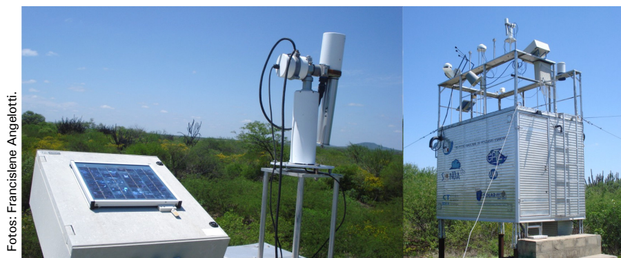
Figura 3. Coleta de dados de radiação solar e velocidade do vento em Petrolina, PE.
