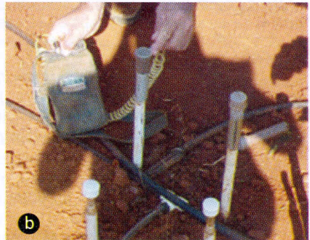
Figura 5. Detalhes do tensiômetro confeccionado para utilização de leitura digital (a) e do leitor digital do potencial, (tensímetro), no momento da leitura (b)
