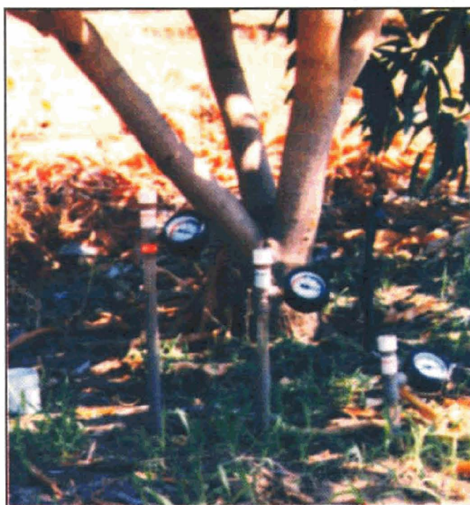
Figura 3. Tensiômetro tipo vacuômetro para determinação do potencial matricial da água no solo.
