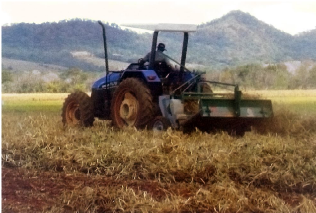
Fig. 5. Virador de feijão em operação, importante para secagem uniforme das plantas.
