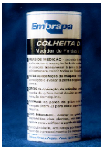
Fig. 16. Medidor de perdas de grãos na colheita do feijoeiro.
