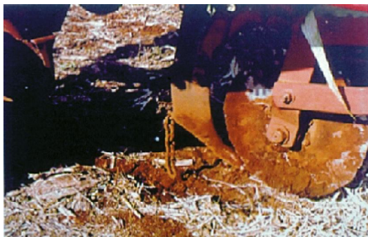
Fig. 3. Adaptação de corrente no mecanismo sulcador da plantadora para evitar o contato adubo-semente.
