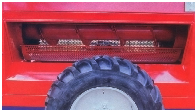
Fig. 9. Sistema de trilha axial de baixo impacto das recolhedoras-trilhadoras.
