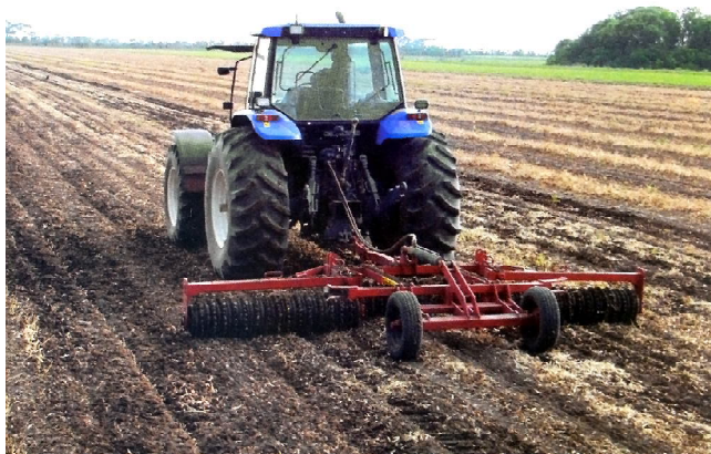
Fig. 1. Modelo de destorroador que elimina irregularidades do solo após a semeadura.
