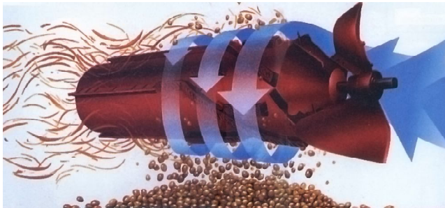
Fig. 11. Cilindro trilhador axial das colhedoras.
