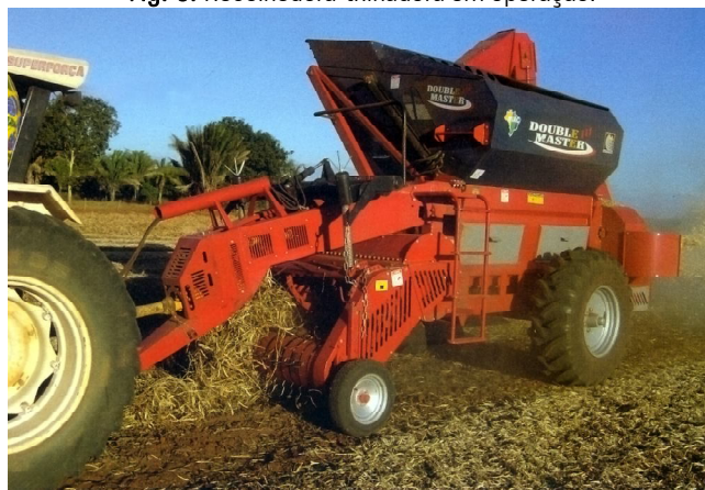
Fig. 7. Recolhedora-trilhadora em operação.
