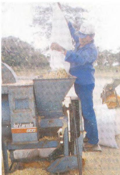
FIG. 4 - Trilhadeira em funcionamento na debulha de feijão caupi.
