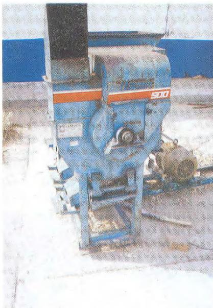
FIG. 3. Trilhadeira elétrica para debulha de feijão caupi.
