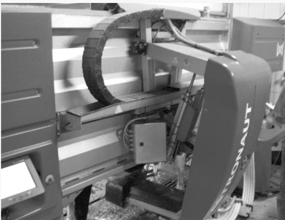
Fig. 6. Detalhes do equipamento de ordenha robotizada.
