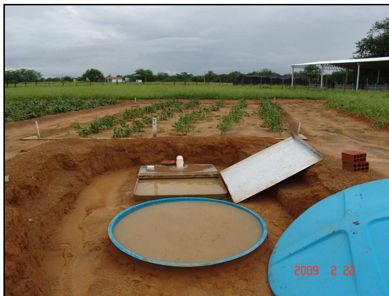
Figura 5. Aspectos das caixas coletoras no tratamento 2, após a ocorrência de chuva.
