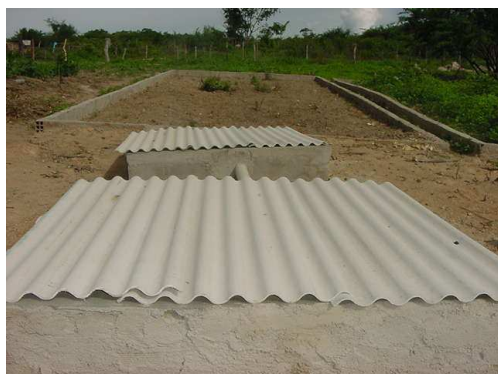
Figura 1. Estrutura para coleta de sedimento e de água.
