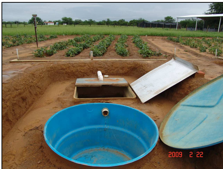
Figura 4. Aspectos das caixas coletoras após a chuva do dia 22 de fevereiro no tratamento 1.
