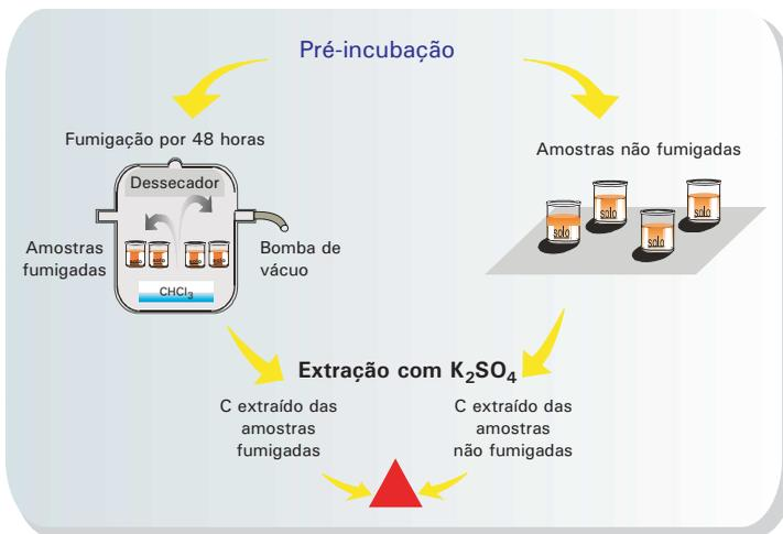
**Fig. 2.** Esquema da determinação do carbono da biomassa microbiana pelo método CFI.
