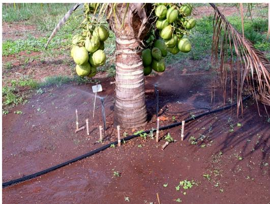
**Fig. 4.** Baterias de tensiômetros instalados no lado de exposição poente da planta.
