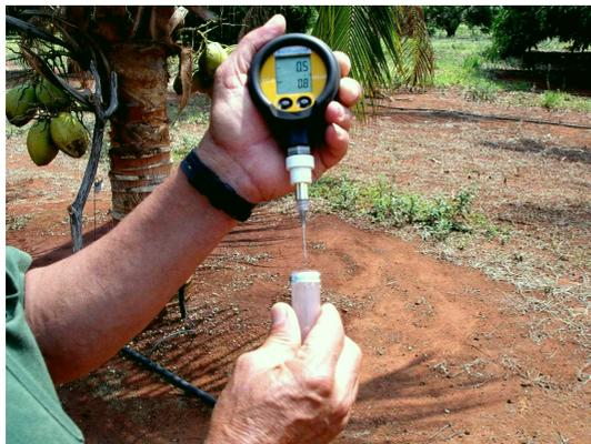
**Fig. 7.** Detalhe da introdução da agulha hipodérmica na extremidade superior do tubo tensiométrico vedada com borracha siliconada.
