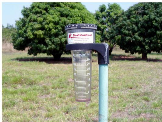
Fig. 10. Pluviômetro de leitura direta usado em conjunção com os dados da estação meteorológica principal para medidas de chuvas.
