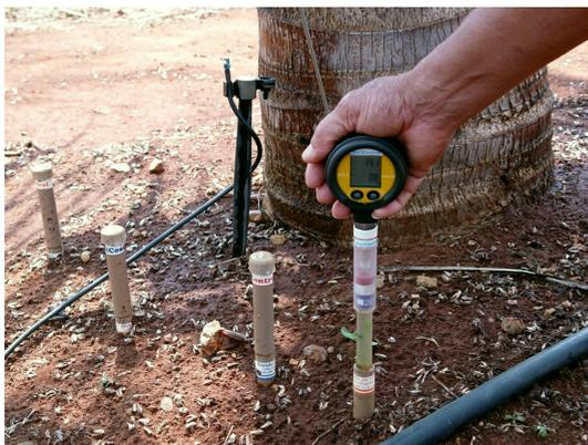
**Fig. 6.** Medições de tensão de água no solo, usando tensímetro digital, introduzido na borracha siliconada por intermédio de agulha hipodérmica.
