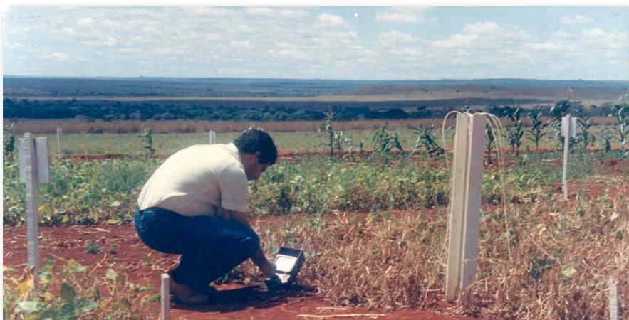
**Fig. 2.** Registro de leituras dos blocos com resistência elétrica (Bouyoucos) instalados nos tratamentos com tensões acima de 0,7 atm.
