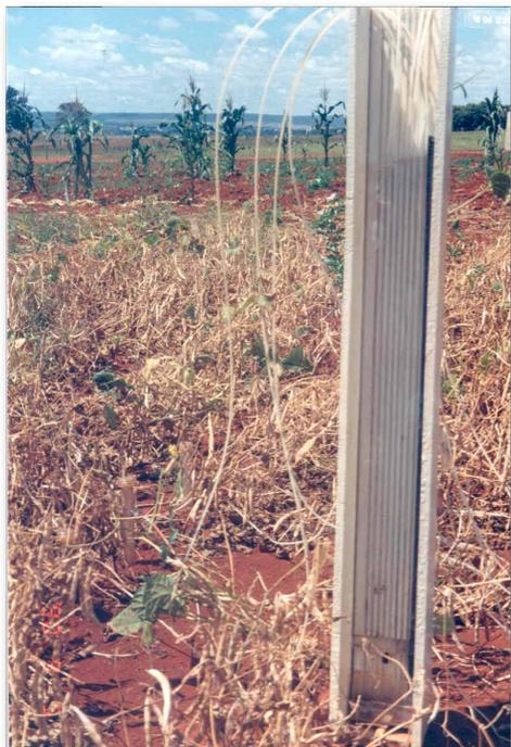
**Fig. 1.** Detalhe da bateria de tensiômetros de mercúrio com a escala de leitura posicionada fora do interior das parcelas para não compactar os locais de instalação dos tensiômetros.
