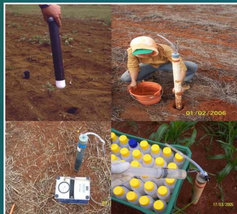
Figura 2. Cápsula porosa e montagem do experimento.
