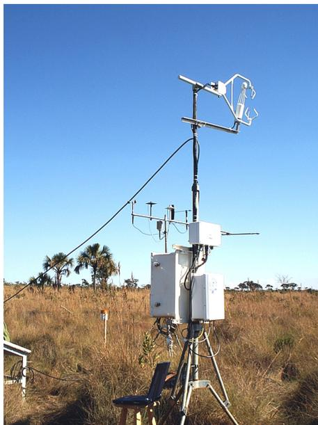
**Fig. 5.** Sistema de Correlação dos Turbilhões em um Campo Úmido do Cerrado (Brasília,DF).
