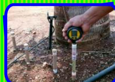
Aspecto de um tubo tensiométrico, sendo lido com um tensiômetro digital de punção em coqueiro irrigado por microaspersão. Embrapa Cerrados, 2005.
