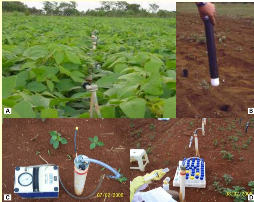
Coleta da solução do solo em cerâmica porosa em experimento de integração lavoura-pecuária: (a) parcela de soja; (b) cápsula porosa; (c) bomba de vácuo para extrair a solução; (d) coleta de amostras.
