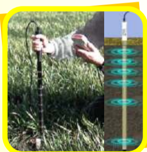
Figura 3. Sonda Profile probe Delta T, usada para medir a evapotranspiração do cafeeiro.
