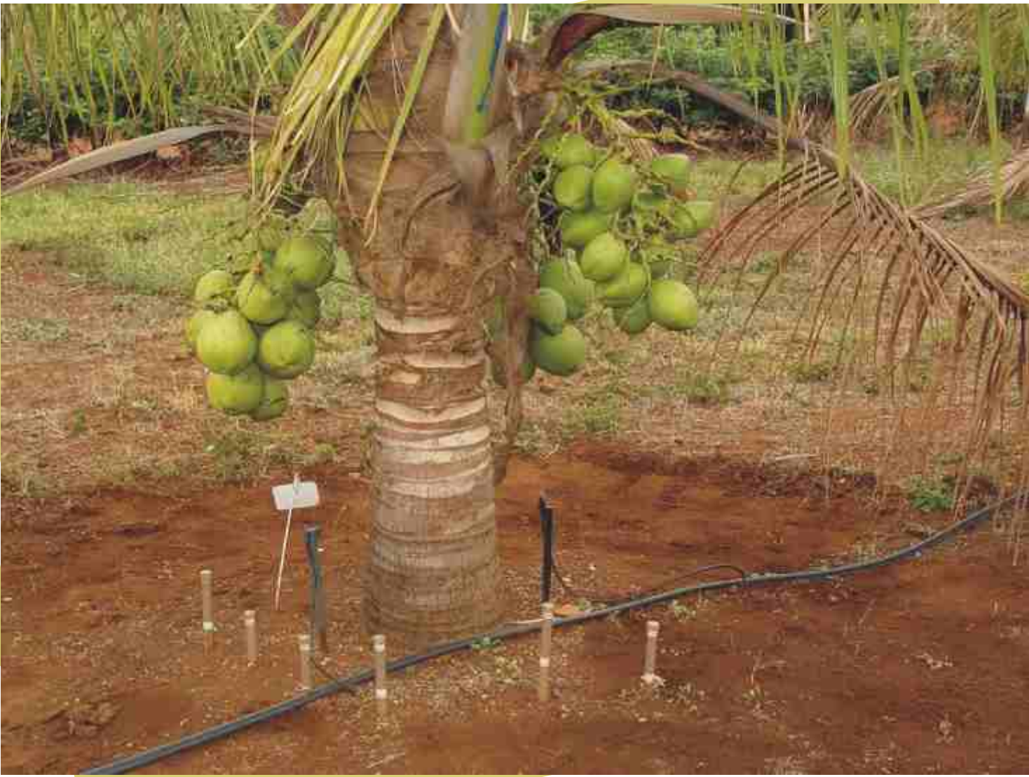
Figura 2. Aspecto da instalação de duas baterias de tensiômetros (15, 30 e 45 cm de profundidade) e dois microaspersores setoriais (180°) por planta de coqueiro- anão.
