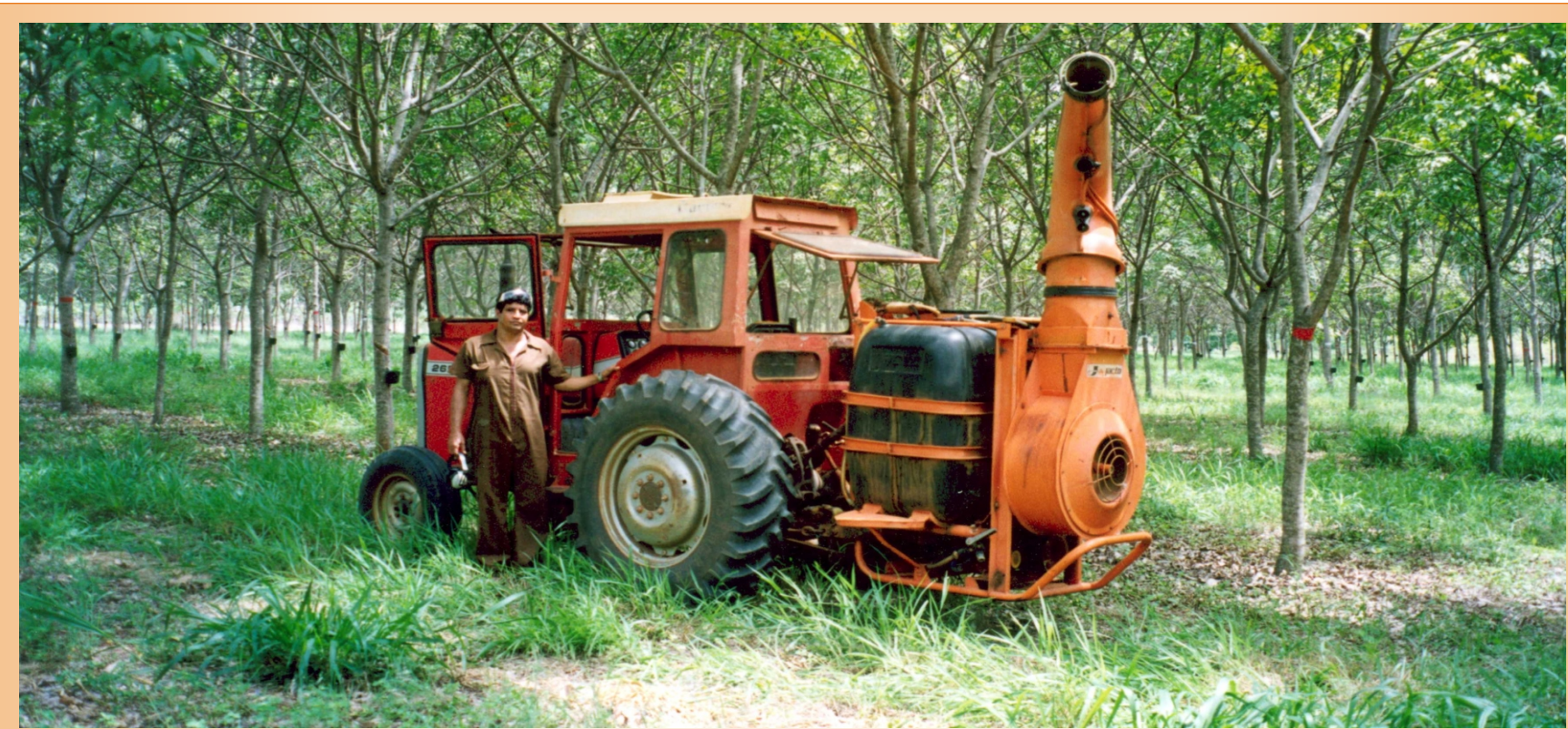
Figura 1. Trator Massey Ferguson modelo 265 com um atomizador Super Jatão 600 acoplado, utilizado nas pulverizações do bioinseticida e do produto químico no seringal.
