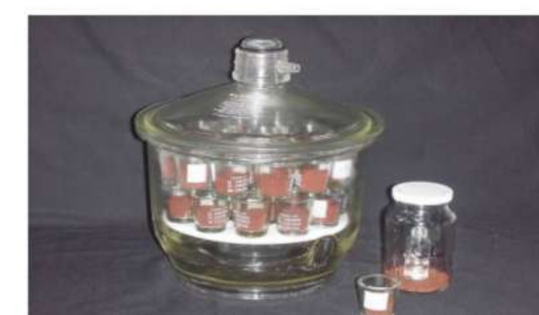
Figura 2. Amostras de solo incubadas pelo método de fumigação-incubação para determinação da biomassa microbiana.
