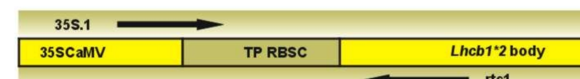
FIG 02. Posição de hibridização dos primers com o gene quimérico Lhcb1*2 , para amplificação por PCR.
