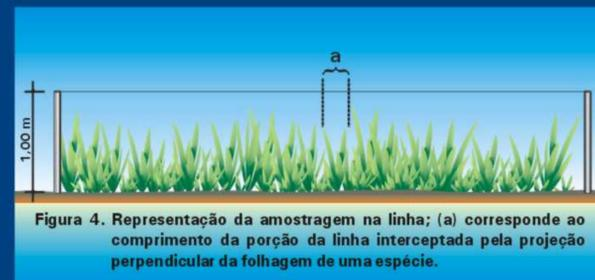
Figura 4. Representação da amostragem na linha; (a) corresponde ao comprimento da porção da linha interceptada pela projeção perpendicular da folhagem de uma espécie.
