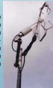
Figura 3 -Analisador aberto para CO<sub>2</sub>/H<sub>2</sub>O (Li-Cor 7500) e anemômetro sônico tridimensional (CSAT3) do Sistema de Correlação dos Turbilhões.
