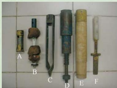
**Fig. 6.** Ferramentas para a instalação: A - pino para colocação da válvula de vedação; B - bucha para limpeza do tubo depois de instalado; C - trado para escavação; D - pino de metal para o início da instalação; E - pino de plástico para o final da instalação; F - espátula para a limpeza do trado.
