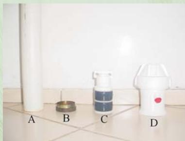
**Fig. 7.** Tubo e acessórios para a instalação: A - tubo de acesso; B - anel de corte e proteção; C - válvula de vedação; D - tampa externa.
