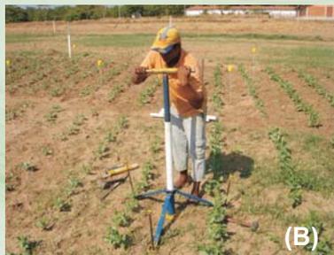
Fig. 4. Colocação do tubo de acesso no suporte de instalação (A) e processo de escavação (B).
