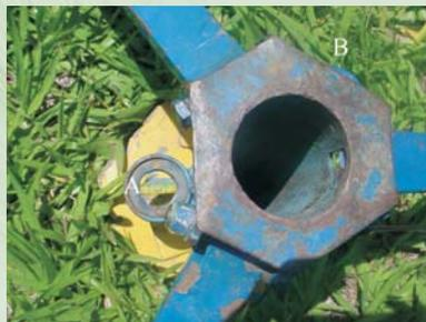
Fig. 2. Suporte para a instalação dos tubos de acesso: A - Bolha de nível; B - trava do tubo.
