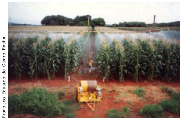
Figura 8. Autopropelido com aspersores montados sobre laterais.
