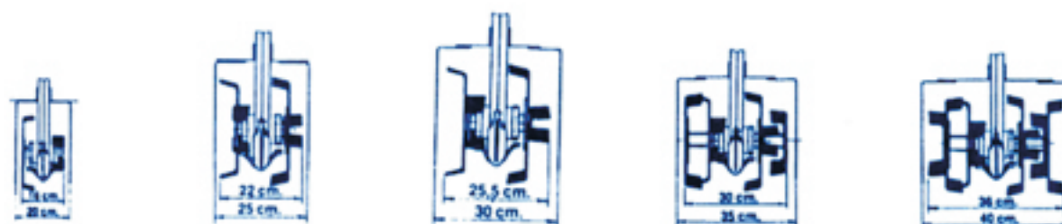
FIG. 3. Vista lateral da enxada rotativa e esquema de variação da largura de trabalho da enxada rotativa considerando as possíveis fixações das pás e da capa de proteção (Fonte – Enxada rotativa múltipla. Caxias do Sul: Lavrale, 1995. Uma folha solta, catálogo).
