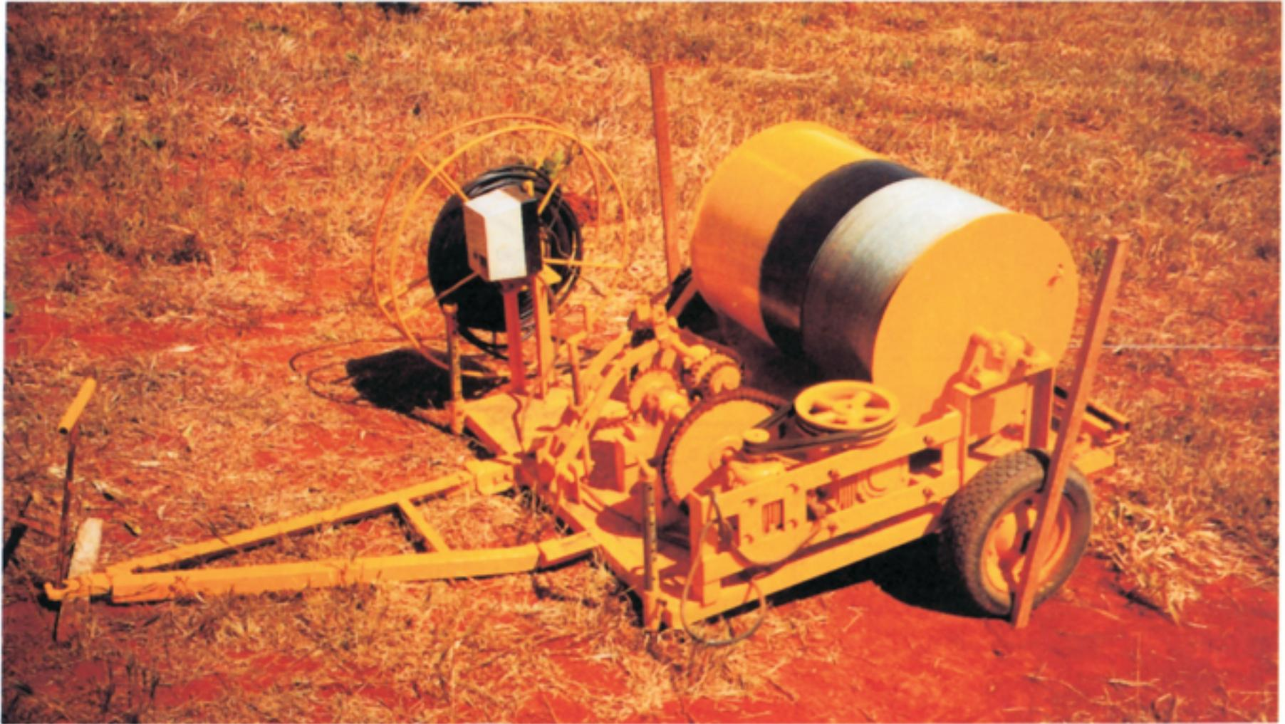
**FIG. 7. Vista lateral esquerda do módulo II, destacando-se ao fundo a chave contactora e o cabo sintenax enrolado em um suporte.**
