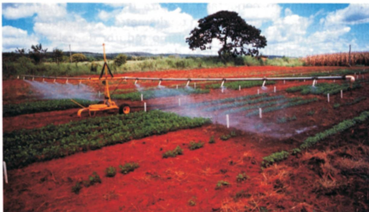
**FIG. 6.** Vistas do equipamento de irrigação, onde o módulo I está operando com altura máxima da barra de aplicação, em cultura de milho, e com altura mínima, em cultura de amendoim.
