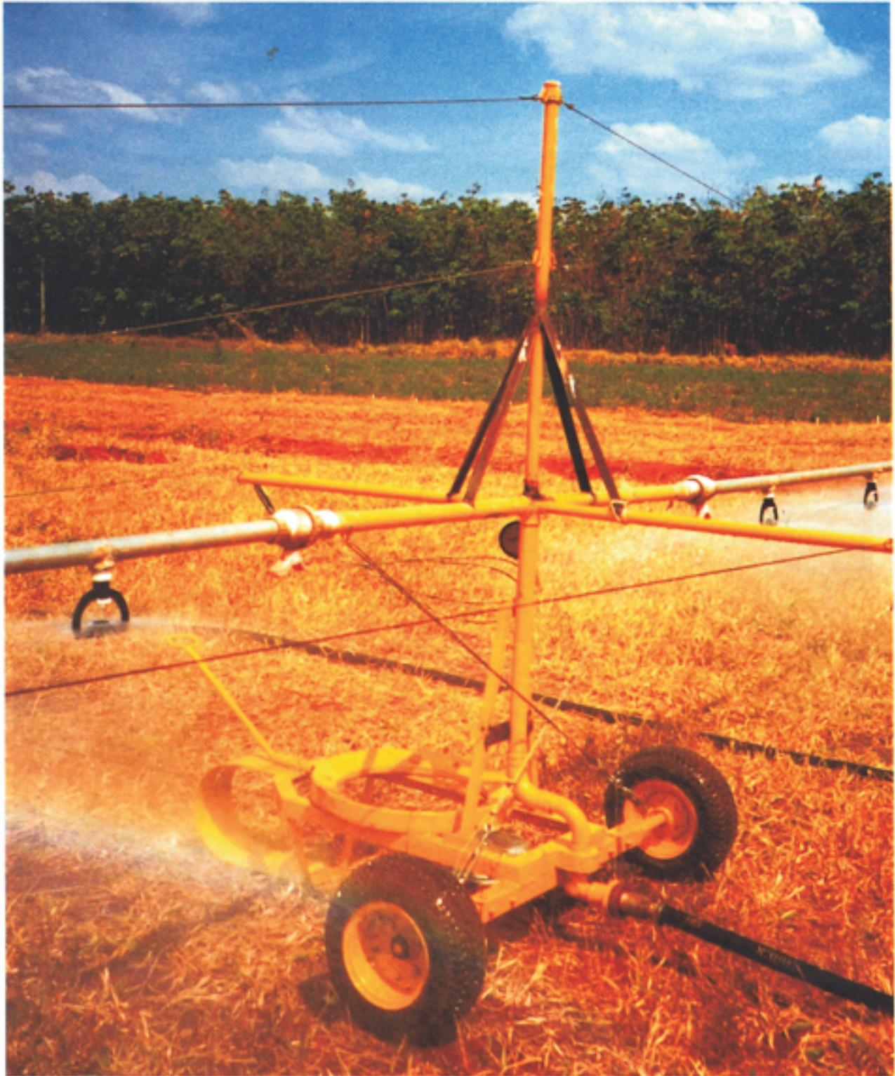
**FIG. 4. Vista do módulo I em operação e dos cabos de sustentação das barras de aplicação.**
