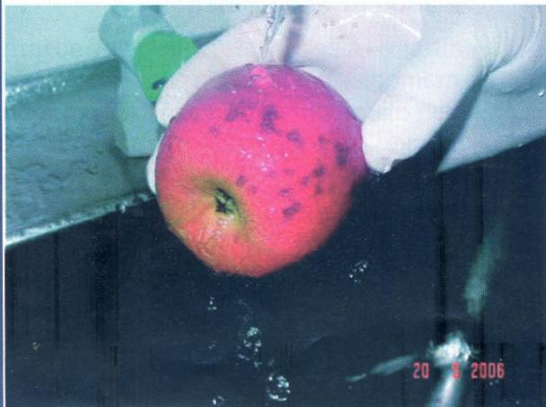
Maçã infiltrada a vácuo com solução colorida.
