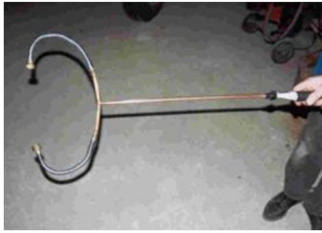
**Figura 15** Haste de dupla saída adaptada ao pulverizador costal
