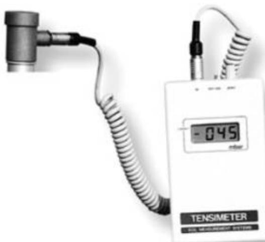
**Figura 3.** Modelo de tensímetro digital de punção. Observa-se que, de um lado faz-se o registro da tensão (em valores negativos) e do outro lado aparece um anel metálico que apresenta uma agulha dentro. Essa agulha perfura a rolha de borracha do tensiômetro (Figura 1) quando vai ser realizada a leitura. Um tensímetro pode ser empregado para fazer a leitura de diversos tensiômetros.
