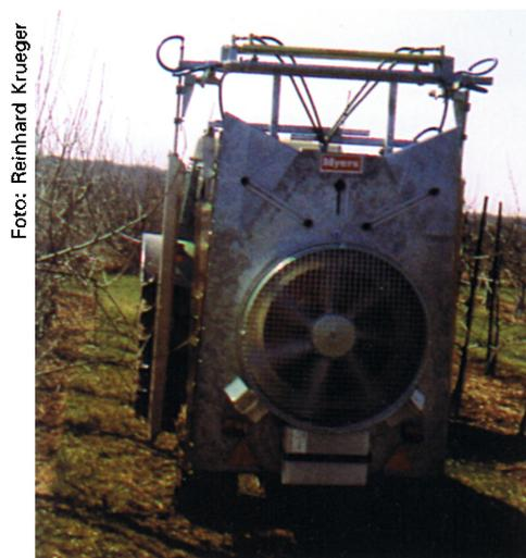
Pulverizadores com dutos superiores para a condução do ar oferecem um melhor ângulo de deslocamento do ar e posicionamento dos bicos em direção à planta. Os bicos ficam mais próximos do alvo, permitindo uma melhor cobertura, redução de volume e de deriva.
