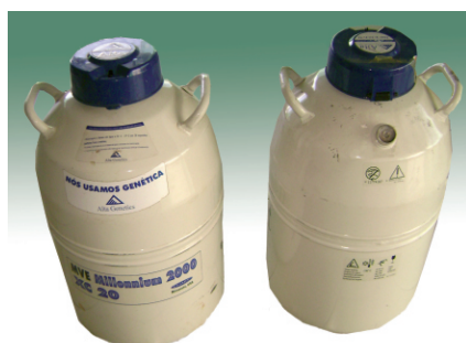
Botijões com nitrogênio líquido para conservar o sêmen em palhetas.
