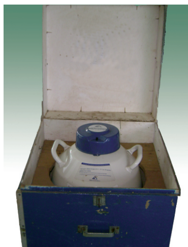
Caixa de madeira para proteger o botijão durante o transporte.
