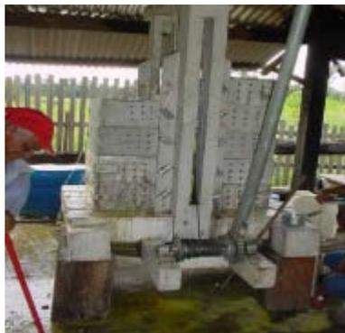
**Fig. 3.** Prensa mecânica para secagem de raspa de mandioca.
