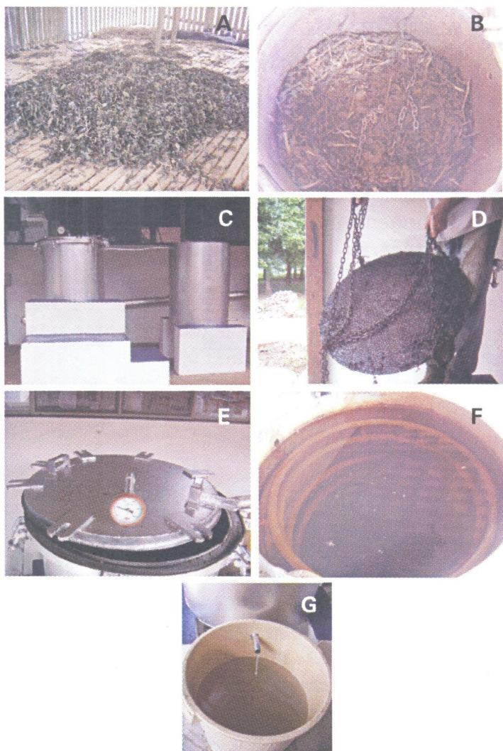
**Fig. 2.** Detalhes do processo de extração do óleo essencial de *P. aduncum* em usina piloto da Embrapa Acre: secagem de folhas e ramos secundários (A); matéria-prima acondicionada no extrator (B); destilador (C); base perfurada removível do extrator (D); tampa de pressão do extrator (E); serpentina para resfriamento (F); coletor de decantação (G).
