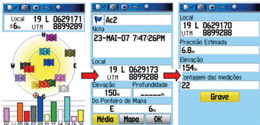
Fig. 3. Telas do GPSmap 76CSx demonstrando a seqüência para obtenção da coordenada média da árvore inventariada.
