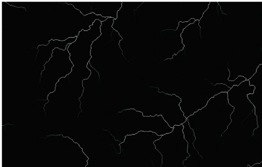
Fig. 7. Resultado do processamento das áreas de acumulação da bacia hidrográfica.
