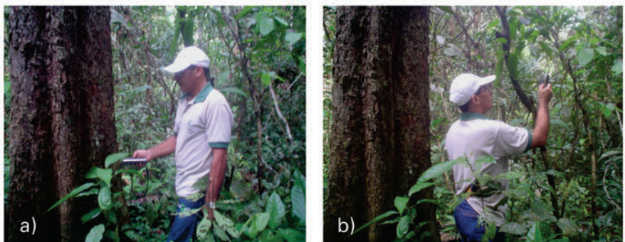
Fig. 1. a) Posicionamento horizontal do GPS (coordenada apropriada com distorção); b) posicionamento vertical do GPS (coordenada apropriada com melhor triangulação de satélites).
