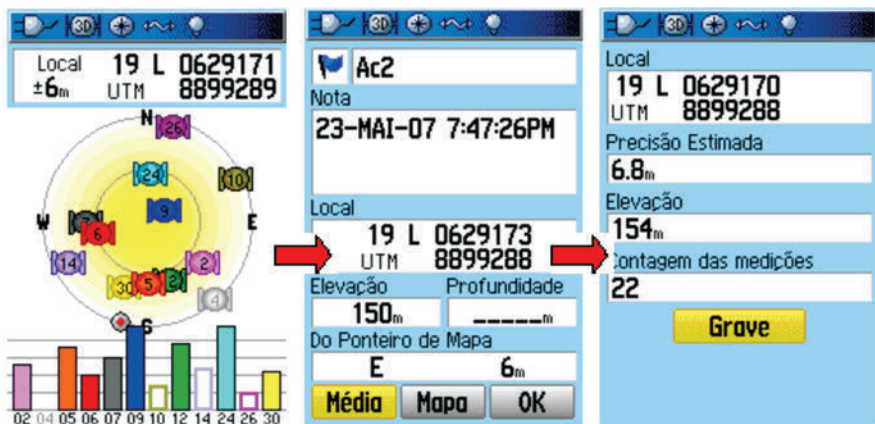
Fig. 3. Telas do GPSmap 76CSx demonstrando a seqüência para obtenção da coordenada média da árvore inventariada.
