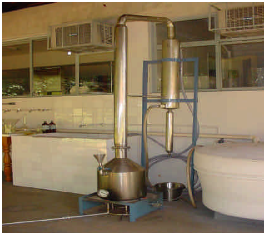
Fig. 1. Destilador de óleo essencial de pimenta longa.
