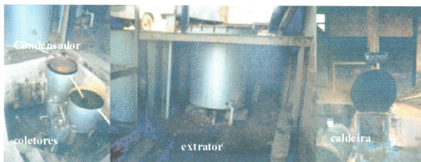
FIG. 1. Destilador comercial para óleo essencial de pimenta longa.
